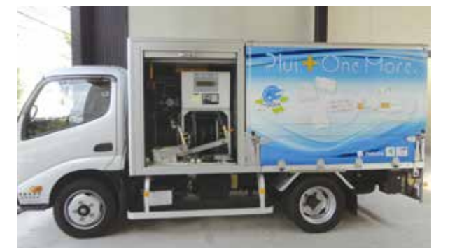
外部への電源供給も可能な「IBCローリーサービス」の配送車両
