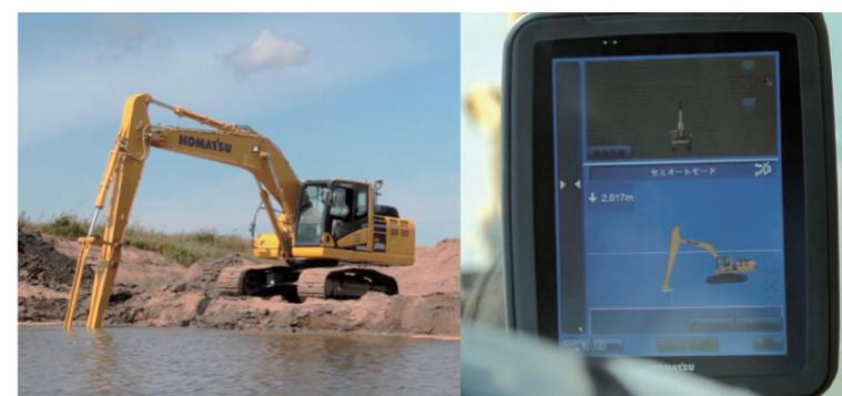
河川での浚渫工事の場合、見えない川底を、設計図面通り正確に掘削する。そして、川底の現況を3Dデータ化し、設計データと照合する。危険な作業は不要となる。
